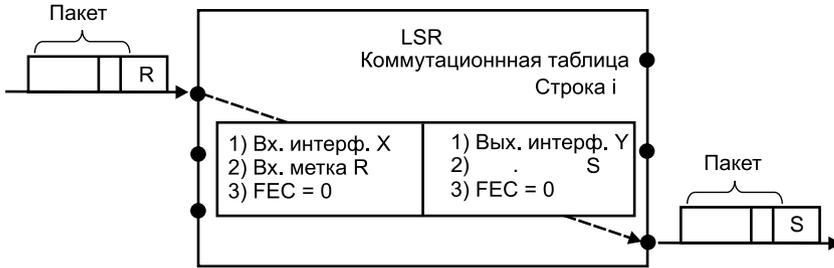
Рис. 4.2. Коммутация пакетов с помощью меток в LSR
