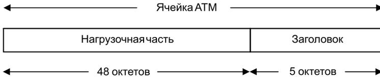
Рис. 7.2. Формат ячейки ATM
