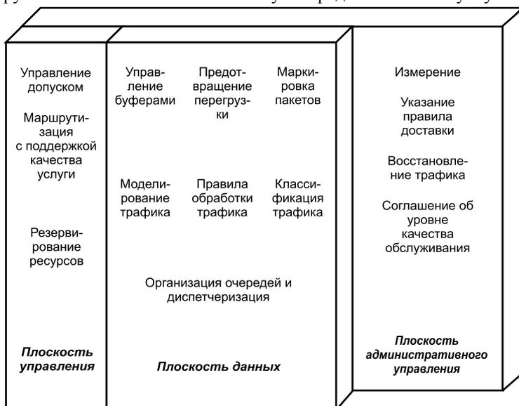
Рис. 7.16. Архитектурная модель для поддержки качества услуг доставки информации в сетях с пакетной коммутацией
