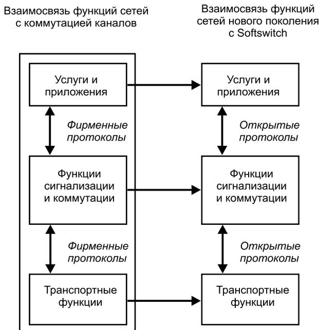
Рис. 10.7. Функции коммутационных станций ТфОП и Softswitch
